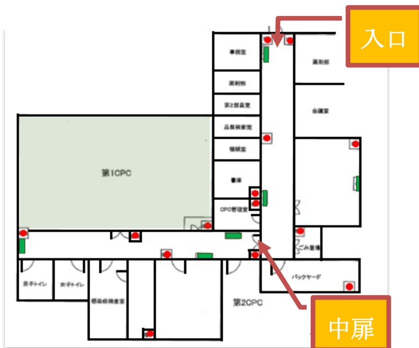
図 B8.3 清浄度管理区域外でのトラップの設置個所。歩行昆虫用トラップ（赤丸）および飛行昆虫用トラップ（緑四角）。入口および中扉を黄色矢印にて示す。
