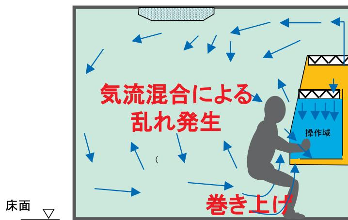
安全キャビネット(BSC)設置した構造設備(CPC)の気流分布の例
