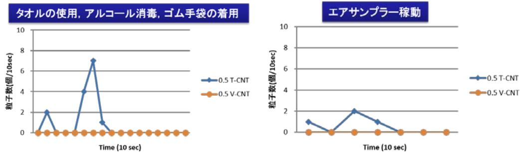
図 B9.1 各モデル操作実施時におけるバイオパーティクルカウンタのカウント結果。V-CNT（黄色）およびT-CNT（青色）をそれぞれ示す。（杉本聰「バイオパーティクルカウンタ導入検討事例」資料より引用）
