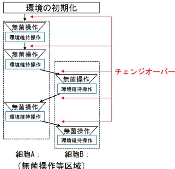
図 A6.1 特定細胞加工物の製造工程およびチェンジオーバーの概念図
